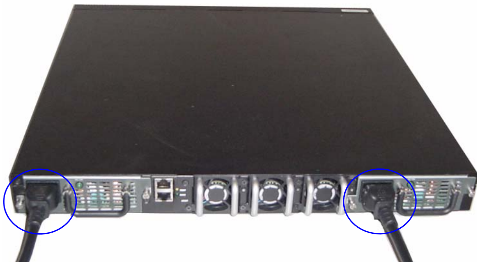
Ilustración 2. Conexión de los cables de alimentación
